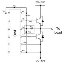
Figure 37: V<sub>S</sub> clamping diode
